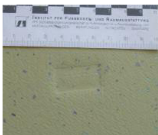
Éles szélű bútorképpel okozott kárkép
