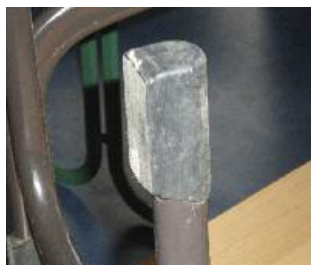
Éles szélű, sérült, elkopott és alkalmatlan, szennyezett szék csúszótalp
