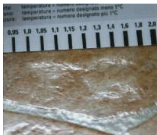
Maradó benyomódások nagy pontszerű terheléstől és kemény csúszótalptól
