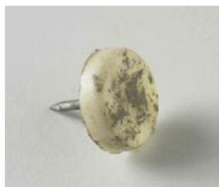
Nylon csúszótalp erősen rátapadt szennyeződéssel nyolc hónap használat után
