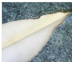
Székgyörgővel okozott túlzott igénybevétel következtében fellépő rétegelválás
