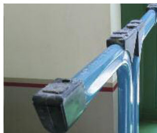
Éles szélű, sérült, elkopott és alkalmatlan, szennyezett szék csúszótalp
