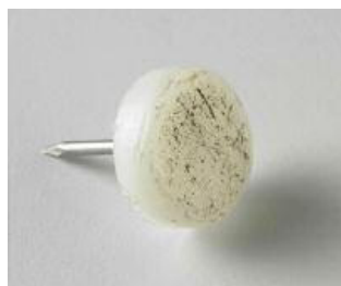
Jelentős mértékben sérült nylon csúszótalp három-négy hónap használat után
