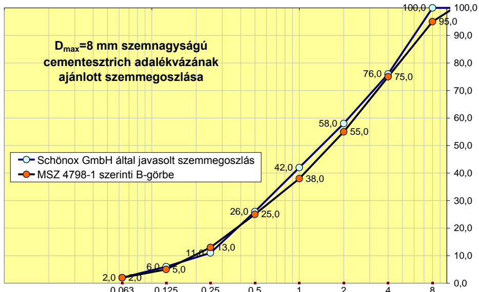
20. ábra: Szemmegoszlási ajánlás d_{max}=8 mm-hez
