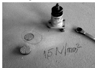
9. ábra: Felületi húzó-tapadószilárdság mérése
