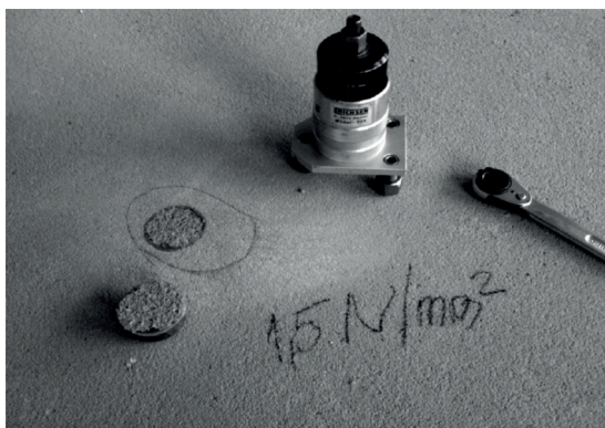
9. ábra Felületi húzó-tapadószilárdság mérése
